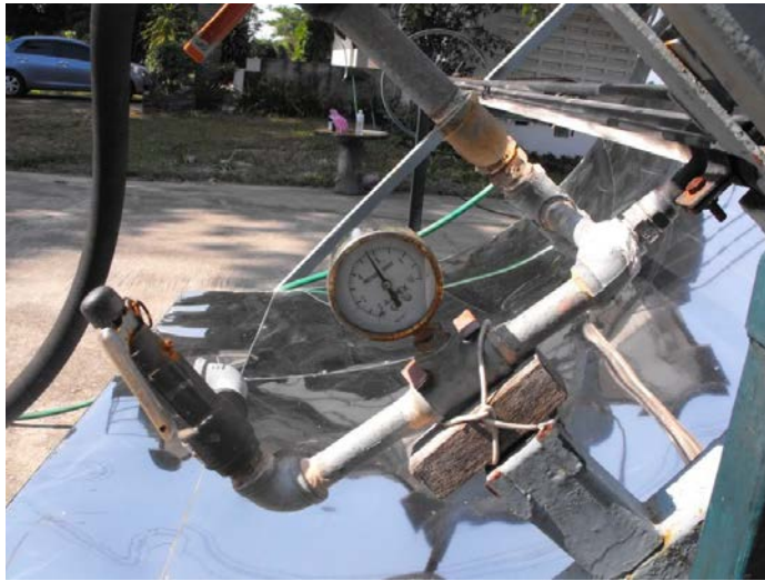
Fig.3: Parabolspiegel (1,5x1m) der thailändischen Solexpumpe mit einem Betriebsdruck von rund 4 Bar im Verdampferrohr.
