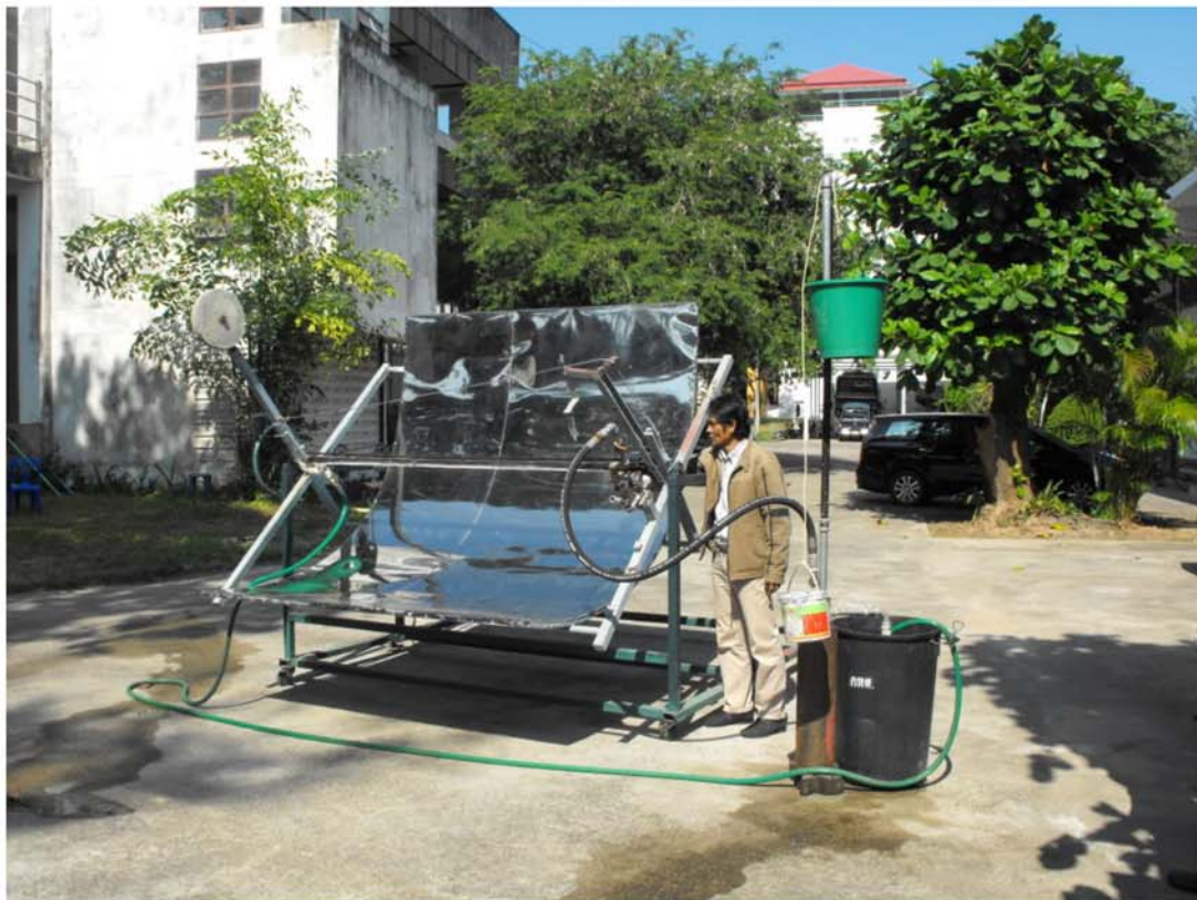
Die österreichische Nano-Solexpumpe (Tischmodell, ohne automatische Nachfüllung) ☆
